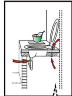
2. Mover el asiento a la cámara vacía asegurándose de encajar bien en la tubería y los orificios dejados para el asiento.
