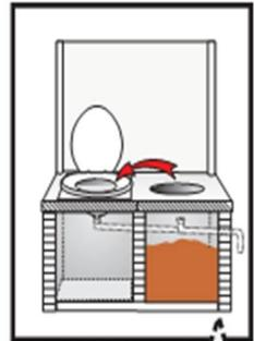
3. Prepara la cámara con un lecho de paja o aserrín para que reciba las deposiciones. La segunda cámara está lista para usar!
